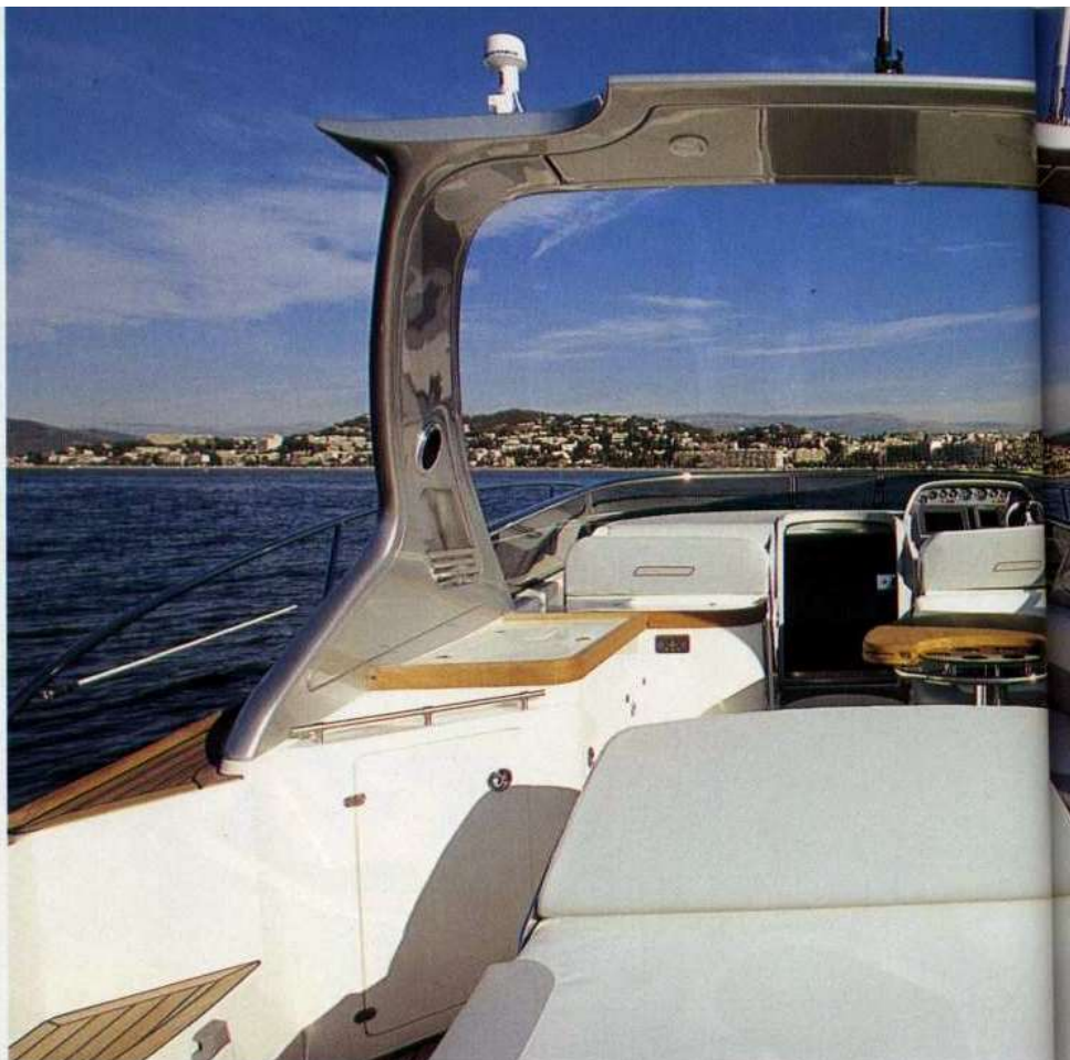
Sopra, una vista del pozzetto da poppa mostra il prendisole centrale, la cucina a scomparsa a sinistra e la dinette a dritta. Sotto, il garage del tender.
